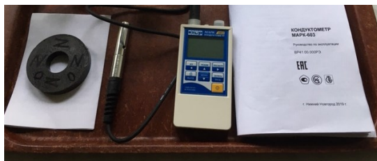
Рисунок 1 - Оборудование при измерении параметров омагничивания воды с использованием кондуктометра МАРК-603
